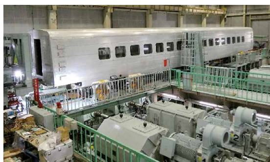
図2 走行状態を模擬した試験の様子
