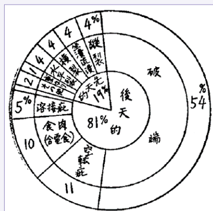
図3 1958年当時におけるレール折損の原因別割合 5)
