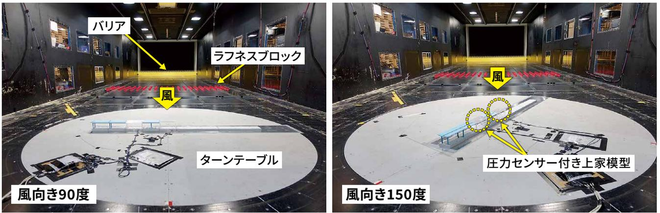
図6 風洞実験の様子
