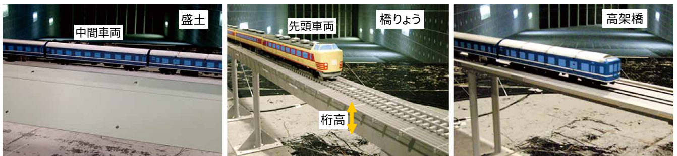
図3 線路構造物の風洞実験模型
