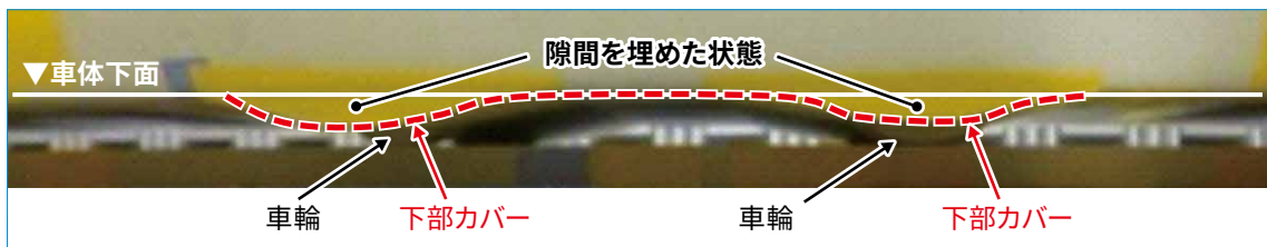
図10 W_2=100\% の条件で隙間を塞いだ様子(台車部側方からの撮影)
