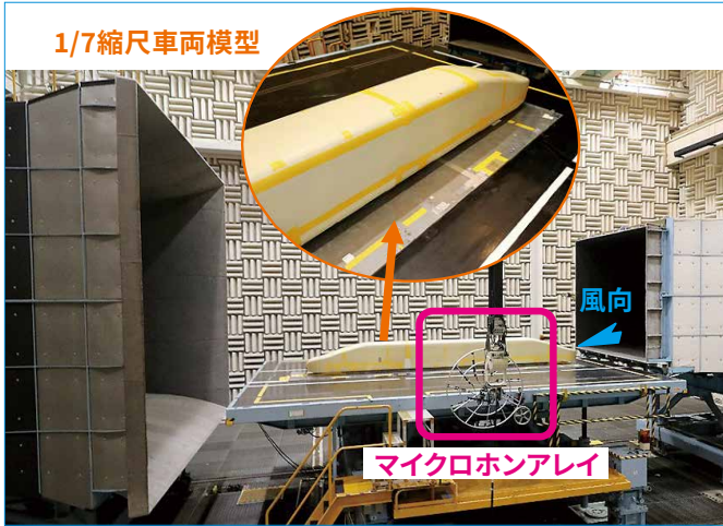
図2 側方からの測定の概況
