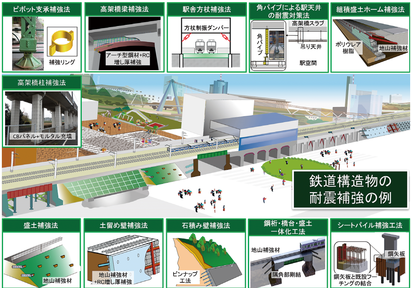
図3 鉄道構造物の耐震補強の例
