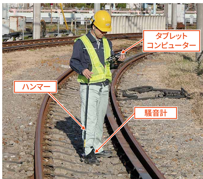
図1 PCまくらぎの敷設状態と劣化判定装置
