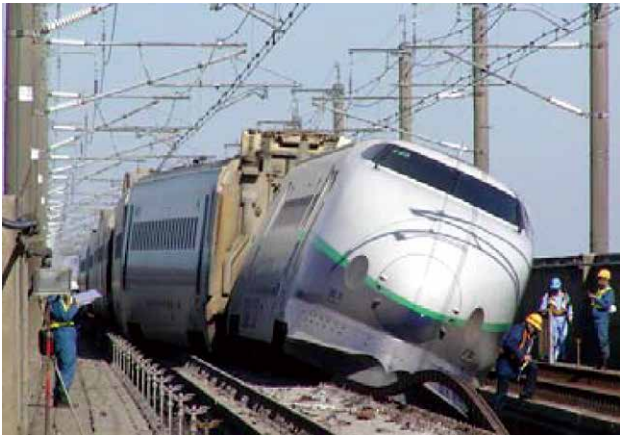
図1 2004年新潟県中越地震で脱線した新幹線列車 (出典:「鉄道事故調査報告書」(運輸安全委員会)( http://www.mlit.go.jp/jtsb/railway/rep-acc/RA2007-8-1.pdf ) (2021年10月13日に利用))
