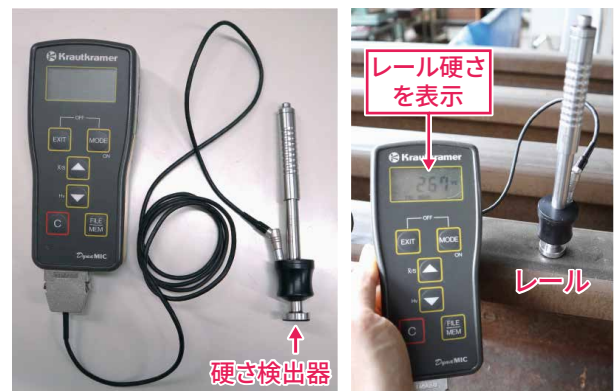
(a) 硬さ計外観 (b) レール硬さ測定の様子 図4 反発式硬さ計
