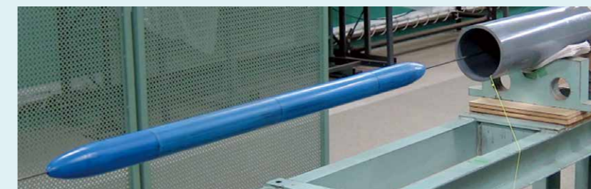
図3 軸対称断面形状の列車模型(従来装置)
