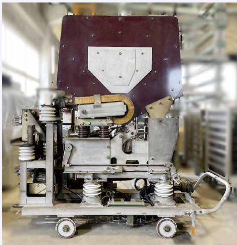
図2 直流高速度気中遮断器の外観の例
