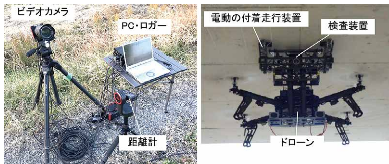
図 ビデオによる多点同期振動測定システム（左図）と構造物検査ドローン（右図）
