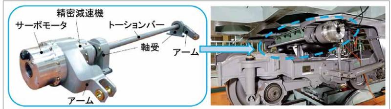
図 改良したアクティブトーションバーと台車への取付状況
