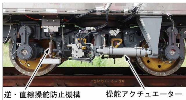
図 試験車両に取り付けたボギー角操舵システム
