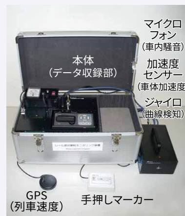
図9 レール波状摩耗モニタリング装置の外観
