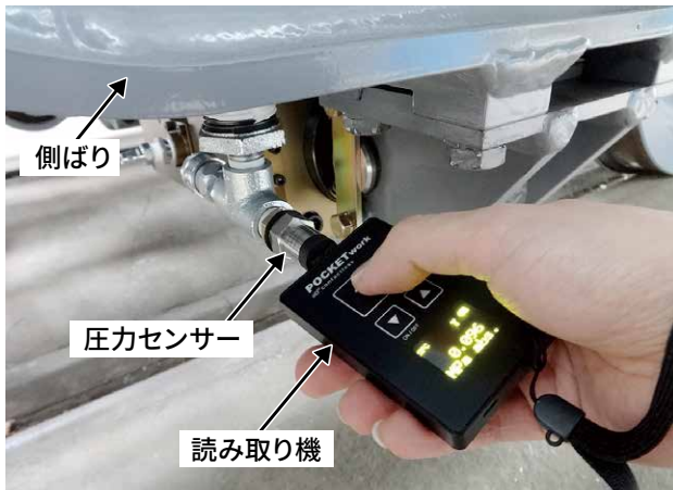
図7 無線圧力センサーによる台車枠内圧測定
