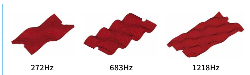
図7 固有周波数と固有モードの例
