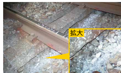
図2 細粒化が進行していないバラスト (I地点：まくらぎ移動後)
