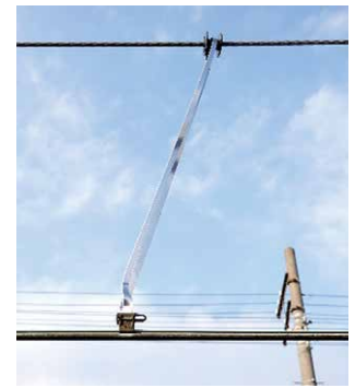
図8 変形したハンガー
