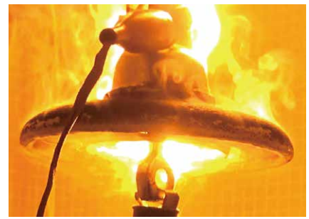
図6 がいしの絶縁性能の低下によるアークの発生状況(模擬試験)
