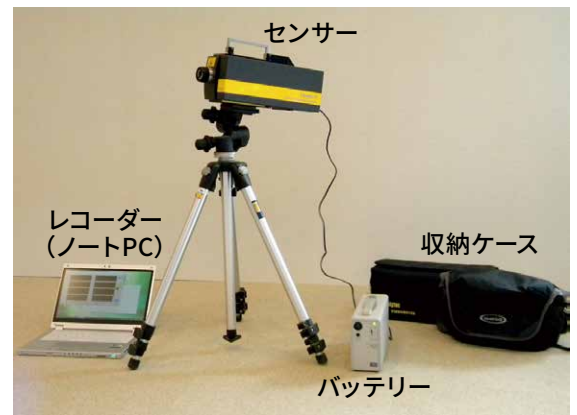
図2 自己振動補正機能付きレーザードップラー速度計 (UドップラーII)
