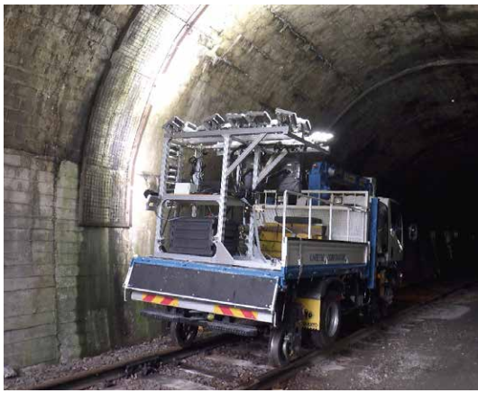
図2 トンネルスキャナーによる撮影
