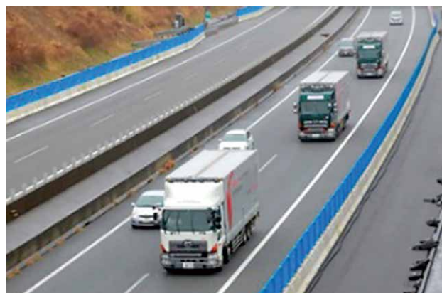
図2 トラックの隊列走行(車両距離自動制御)の実証実験 (提供: ソフトバンク株式会社)
