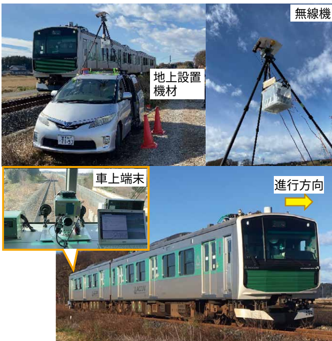
図3 公衆網から自営網へ無線ネットワークを切替える技術の実証実験 6) に加筆
