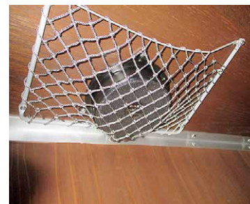
図4 振動スピーカー設置状況
