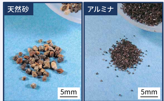
図7 砂まき器用の天然砂とセラジェット用のアルミナの比較
