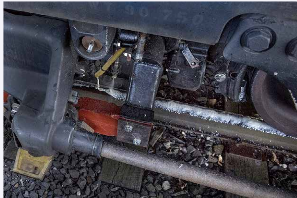
図10 レール上に散布されるサンダイト
