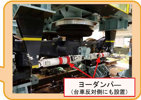
図8 ヨーダンパー配置変更の効果を確認する実台車加振試験
