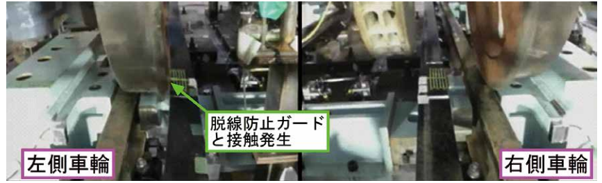
図4 脱線防止ガード接触時の様子
