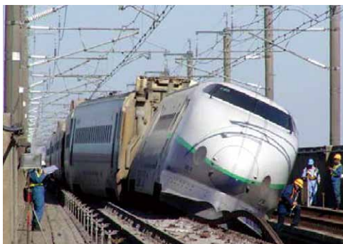
図1 2004年新潟県中越地震で脱線した新幹線列車 (出典:「鉄道事故調査報告書」(運輸安全委員会)( http://www.mlit.go.jp/jtsb/railway/rep-acc/RA2007-8-1.pdf ) (2021年1月21日に利用))
