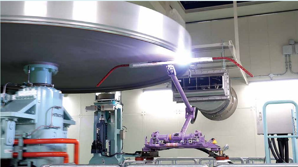
図2 高速パンタグラフ試験装置を使用した試験の例 (回転速度：360km/h、電圧電流：交流200V、600A)
