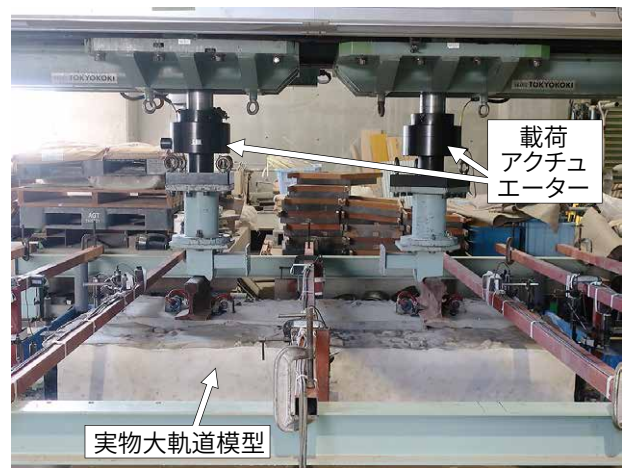
図4 载荷試験の状況 (総合路盤試験装置)
