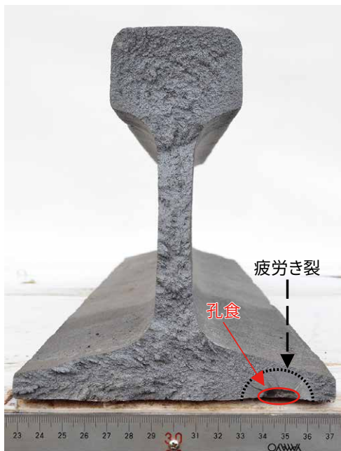
図7 レール曲げ疲労試験後のレールの一例(破断面)
