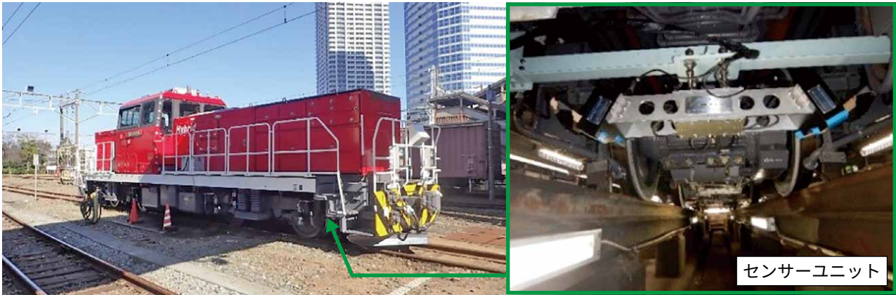
図3 低コスト軌道検測システムの入換機関車への搭載例
