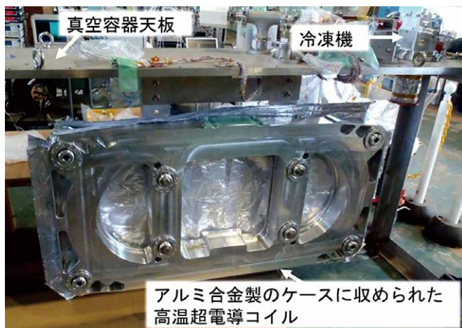
図3 組み立て途中の高温超電導磁石
