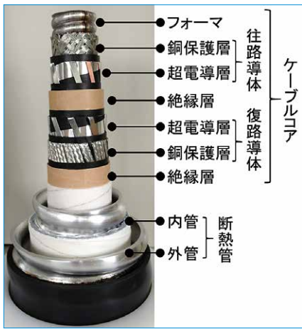
図1 超電導き電ケーブルの構造例
