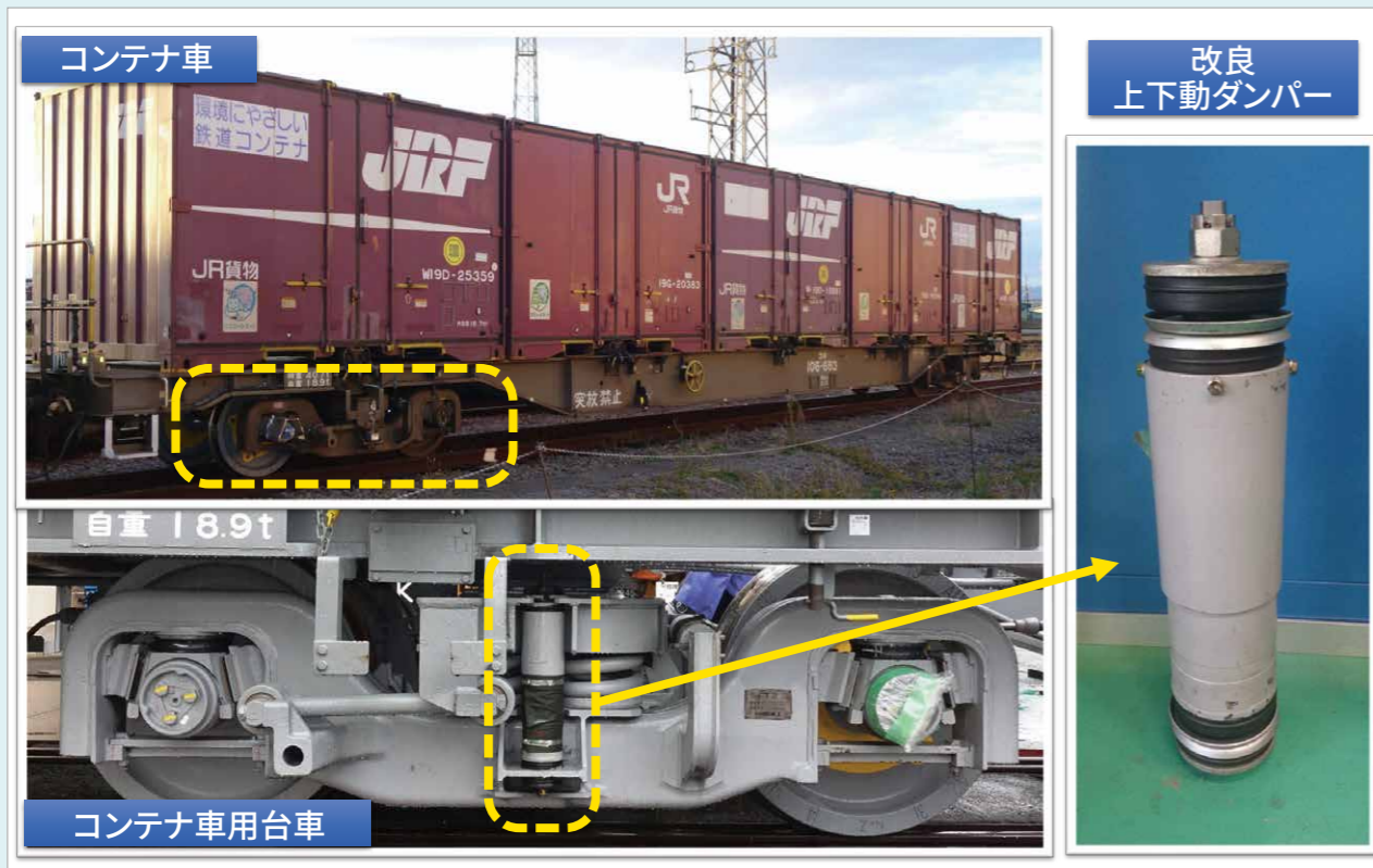
図1 コンテナ車用台車の改良上下動ダンパー
