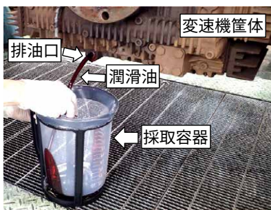
図3 潤滑油採取の例 (気動車用変速機)
