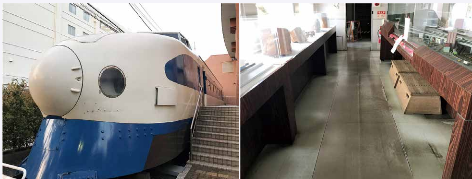
図2 951系新幹線試験車両(左)と車内のポリ塩化ビニル製床材(右) (国分寺市ひかりプラザ展示車両)
