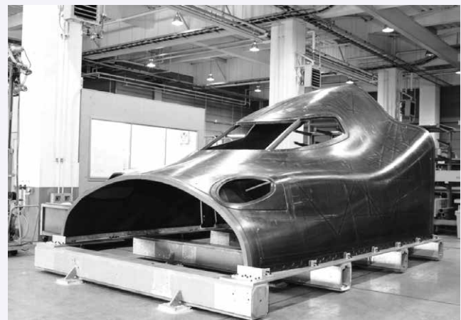
図7 CFRP先頭構体
