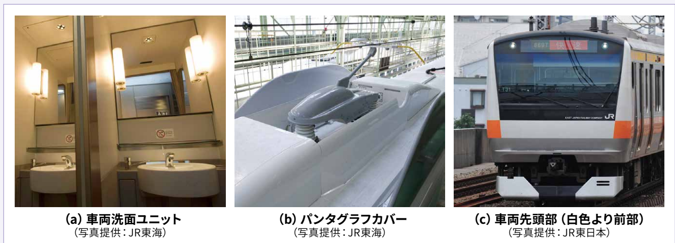
図5 GFRPの適用例
