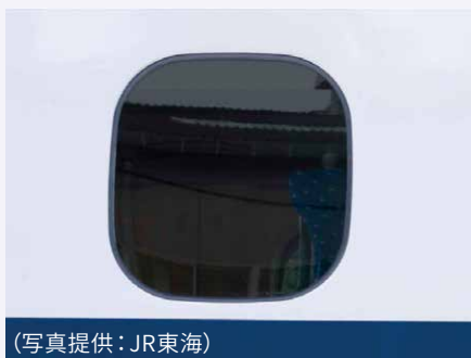
図4 窓ガラスへのポリカーボネートの適用例
