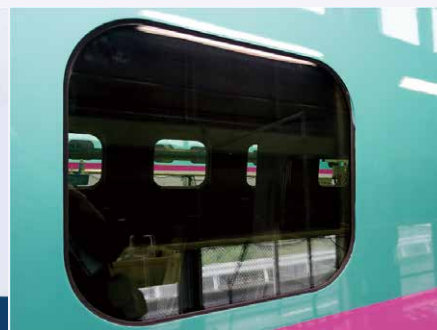
図4 窓ガラスへのポリカーボネートの適用例
