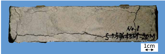
図9 高湿度の空气中でDEFのみによって生じた膨張ひび割れ
