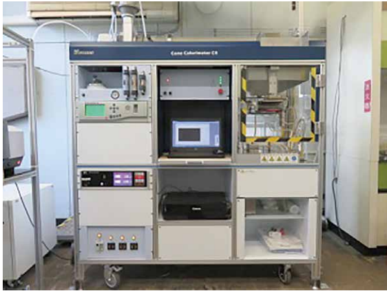
図2 CCM試験装置の外観
