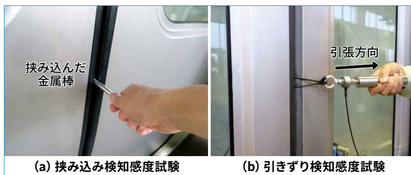
図4 検知感度試験の状況
