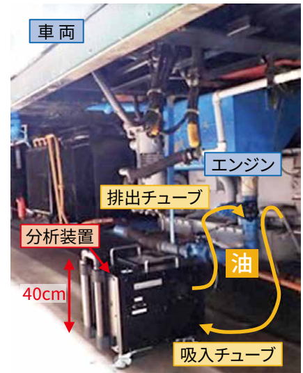
図7 開発した潤滑油分析装置
