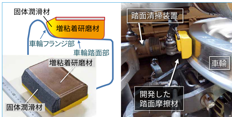
図5 車輪フランジの摩耗を低減する踏面摩擦材
