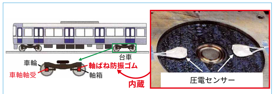
図10 軸ばね防振ゴムとセンサーの埋設状況
