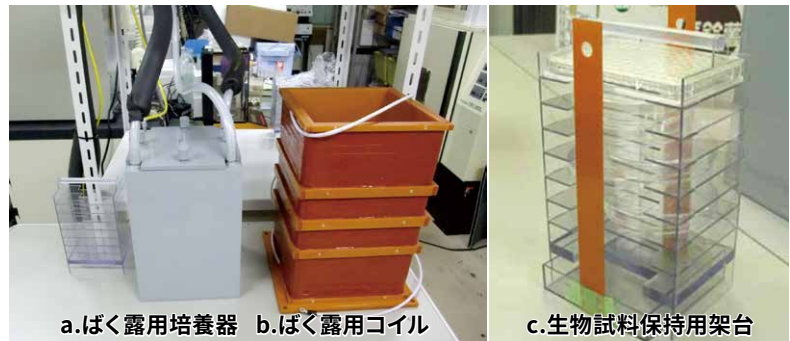
図6 細胞用IF磁界ばく露装置
