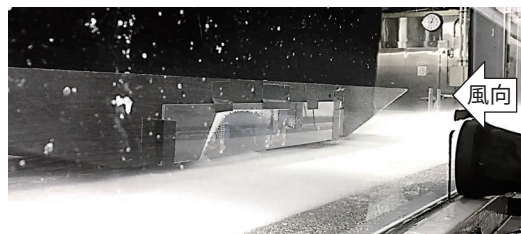
図3 台車模型の着雪実験 3)
