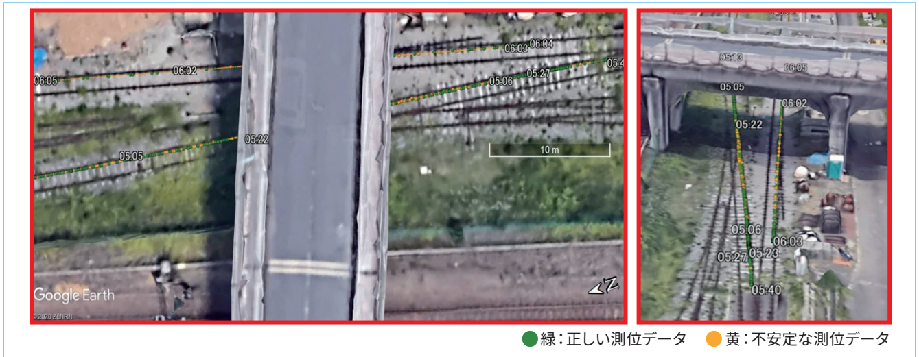
図9 高架橋付近におけるRTK方式による測位結果(写真はGoogle Earthより抜粋)
