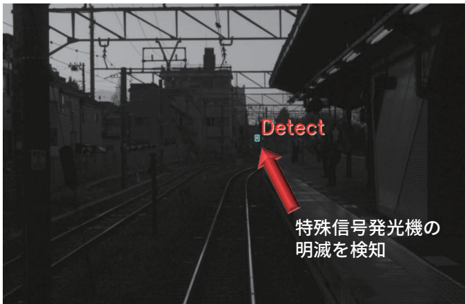
図8 営業線において点滅を検知した例
