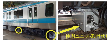
図2 慣性正矢軌道検測装置、軌道保守管理データベースシステムLABOCS
