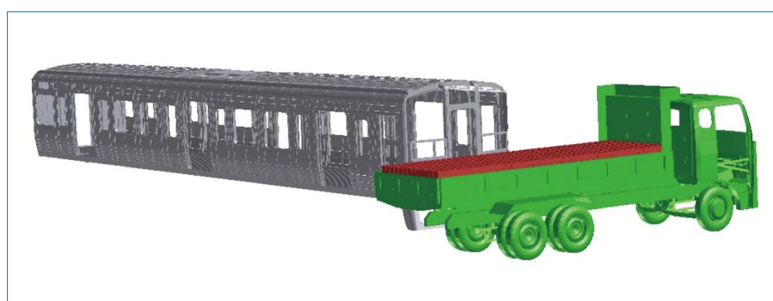
図3 衝突時の車両のFEM解析
