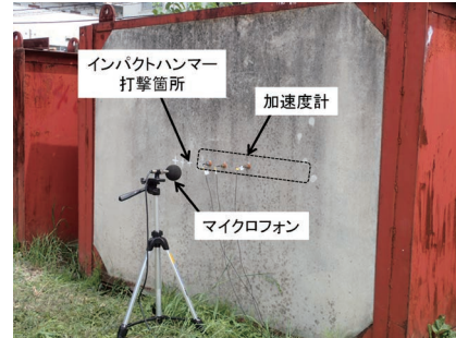
図 覆工の打音調査を模擬した打音試験
