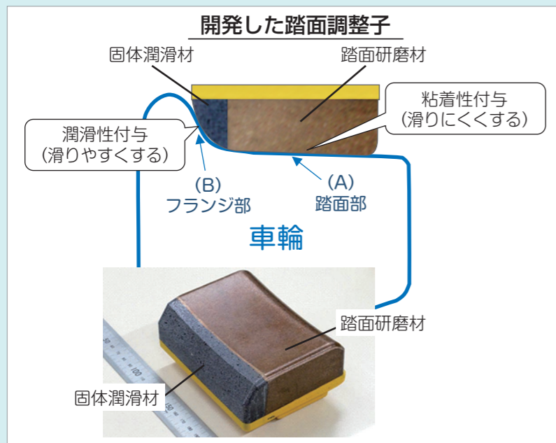
図1 開発した踏面調整子(粘着性能と潤滑性能を付与)
