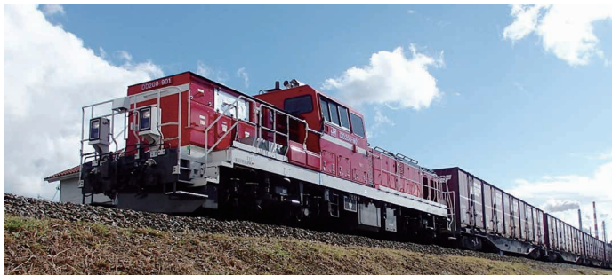
図1 DD200形式勾配起動試験の様子（仙石線）
