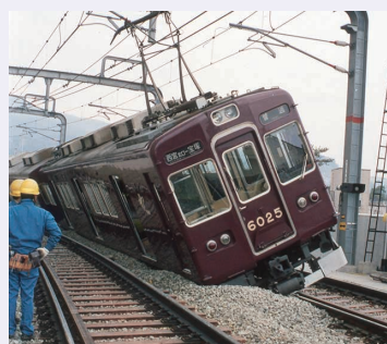
図1 1995年兵庫県南部地震の揺れにより脱線した電車（提供：阪急電鉄）
