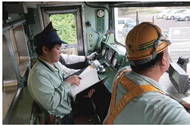
鉄道総研の現地調査風景（軌道状態把握のための動揺測定）
